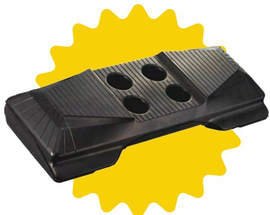
Les roadliners Maxitrax se boulonnent directement sur la chaîne fer nue de la machine, et remplacent les tuiles en acier. Ils sont durables et très résistants aux défaillances et sont dotés d'une structure en acier dense enrobée de caoutchouc naturel de haute qualité.
