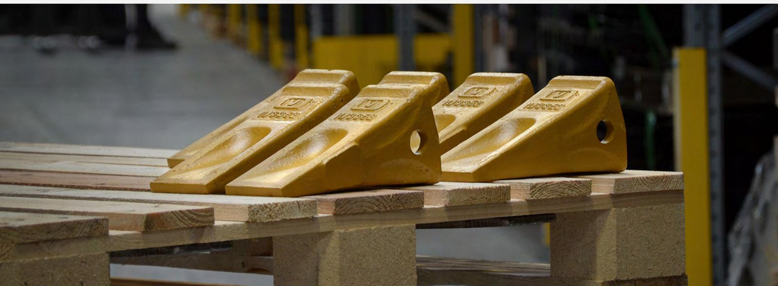
Si vous avez besoin d'une plus grande polyvalence dans votre travail, le système en deux parties sera plus flexible pour vous. Il vous permettra de passer d'une dent à usage général, à une dent type roche le plus aisément et rapidement possible. La dent à claveter offre une force de pénétration plus grande grâce au support soudé sur le godet.
