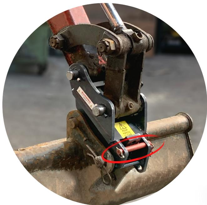
L'axe de sécurité doit être inséré et fixé par une goupille avant et pendant le fonctionnement.
